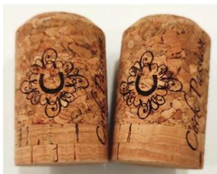
A rolha **CRYSTALTECH** é uma rolha com corpo de aglomerado e com 1 ou 2 discos de cortiça colados na mesma extremidade, 0+1 ou 0+2. Para colar os discos de cortiça são usados aglutinantes aprovados para serem usadas em produtos que vão estar em contacto com alimentos.
